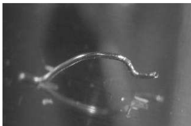
Рисунок 14 – Отрыв проволоки в месте сварки в результате недостаточной ее предварительной деформации
