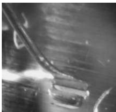
а) Проволока, расплющенная с одной стороны вследствие неправильной регулировки стопорного винта устройства сдвига
